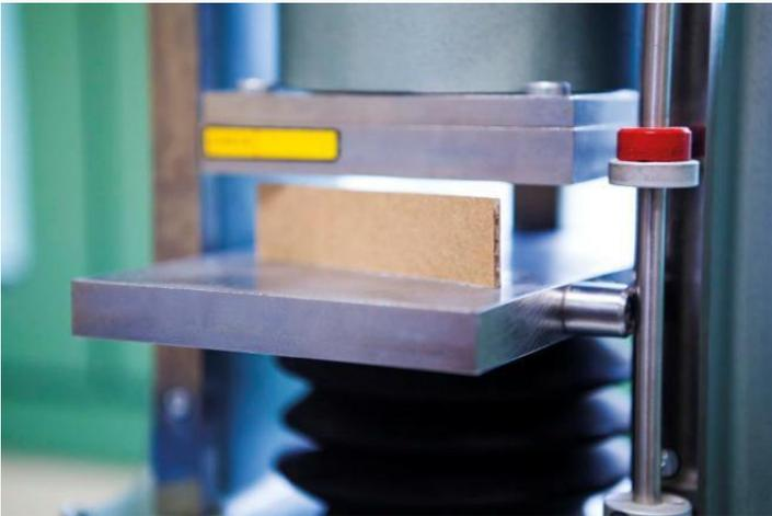
**BCT: è la prova di compressione su scatole di cartone ondulato, è un test rapido per individuare la resistenza alla compressione verticale e quindi correlato con l'accatastamento.**
